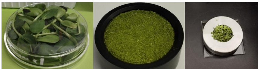
9. ábra: Friss napraforgó mikroöldség Petri-csészében, méréshez előkészítve (balra); szárított, őrölt napraforgó mikroöldség (középen); szárított minták zafírablakos mintatartóban a készülék detektálási területére helyezve (jobbra)
